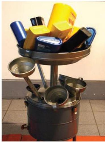
**Equipamento para escoamento de óleo lubrificante**
